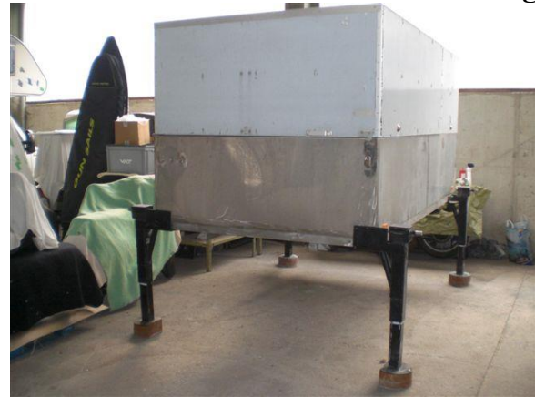
Stützen zum Abstellen der Heizung
