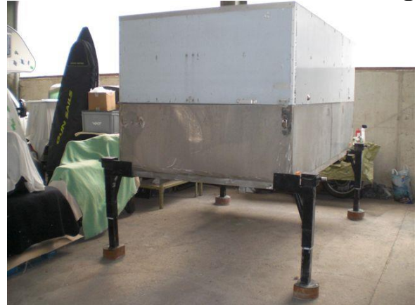
Stützen zum Abstellen der Heizung
